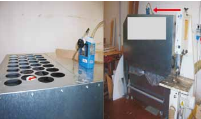
Figura 4: Campionatore a 15 - 20 cm dall'uscita della griglia di espulsione dell'aria filtrata dall'impianto
